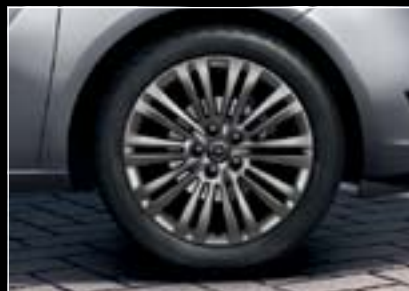
Llantas de aleación, 6,5 J x 16", diseño de 10 radios dobles y acabado titanio brillante, neumáticos 205/55 R 16 (PXV & 14R). 4
