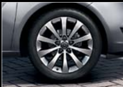
Llantas de aleación, 7 J x 17", con diseño de 10 radios, neumáticos 225/45 R 17 (PWH). 1
