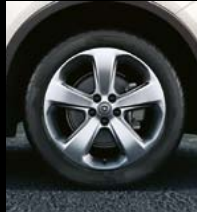
Llantas de aleación 18", Plata Sterling. Con 5 radios y neumáticos 215/55 R 18. De serie en Selective.
