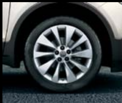
Llantas de aleación 18". Diseño de 10 radios. Neumáticos 215/55 R 18. De serie en Excellence.
