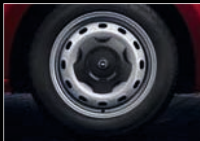
Llantas de acero de 16" con embellecedor central., 6 J x 16". Neumáticos 205/65 R 16.
