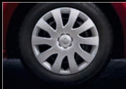
Llantas de acero, 6 J x 16", con embellecedor completo de 10 radios. Neumáticos 215/65 R 16.
