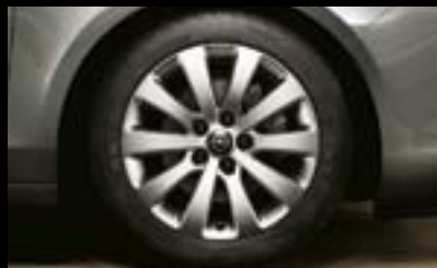
Llantas de aleación, 7 J x 17", diseño multi-radio, neumáticos 225/50 R 17 (PGQ).
