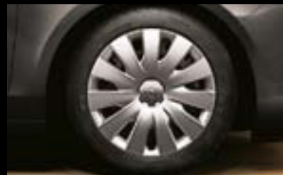
Llantas de acero con embellecedor, 7 J x 17", neumáticos 225/50 R 17 (PWP y NQ1).
