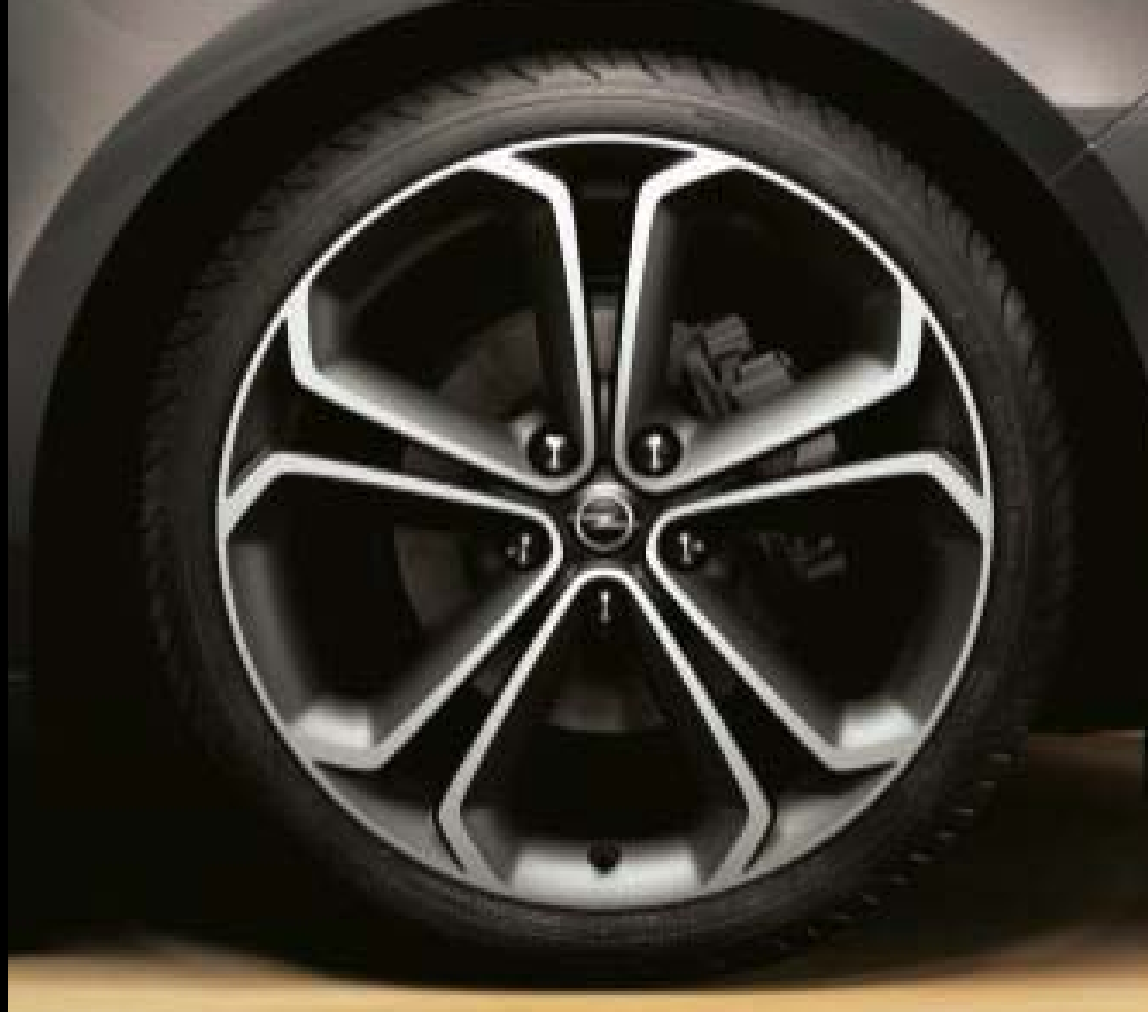
Llantas de aleación, Bicolor, 8 J x 19", diseño de 5 radios, neumáticos 235/40 R 19 (PZT).
