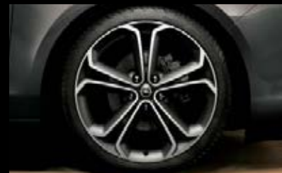
Llantas de aleación, Bicolor, 8 J x 19", diseño 5 radios, neumáticos 235/40 R 19 (PZT).
