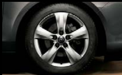
Llantas de aleación, 7 J x 17", diseño de 5 radios, neumáticos 225/50 R 17 (PWX).
