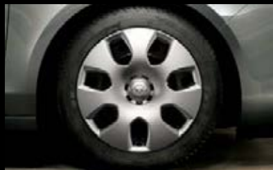
Llantas de acero con embellecedor, 6,5 J x 16", neumáticos 215/60 R 16 (PWM).
