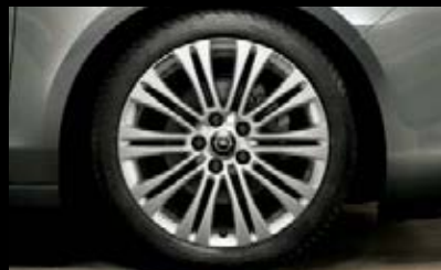
Llantas de aleación, 8 J x 18", diseño multi-radio, neumáticos 235/45 R 18 (WQN).
