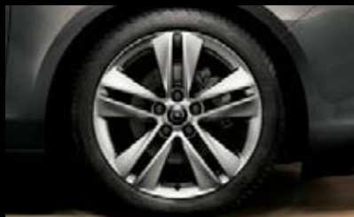
Llantas de aleación, 8 J x 18", diseño 5 radios dobles, neumáticos 235/45 R 18 (PZJ).
