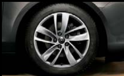
Llantas de aleación, 8 J x 18", diseño 5 radios divididos, neumáticos 235/45 R 18 (PTW).
