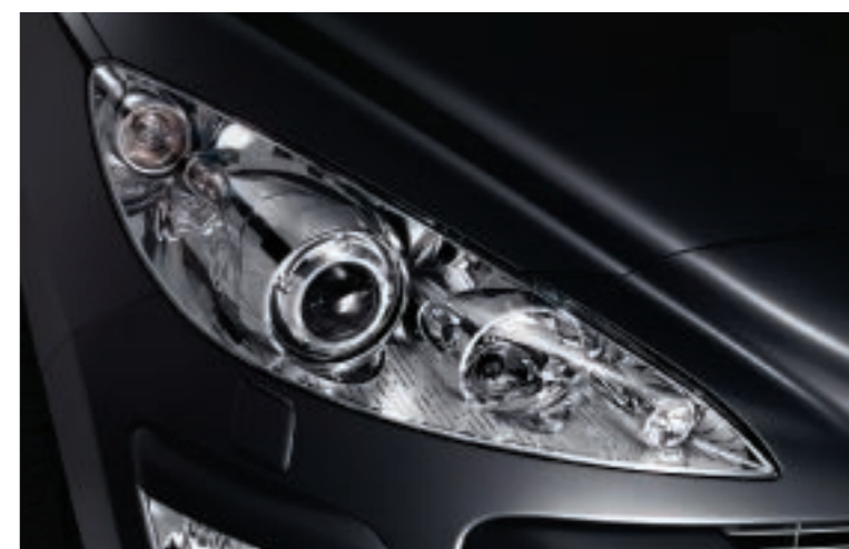
Los faros direccionales* pivotan en función del ángulo del volante y la velocidad del vehículo.
