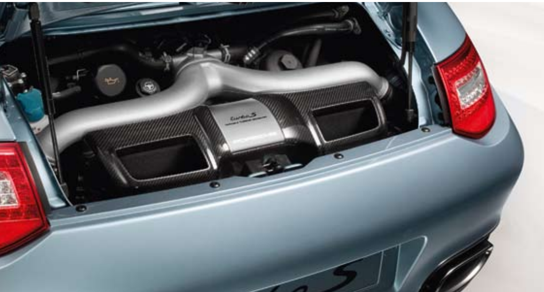
Motor con carcasa del filtro de aire de carbono visto de los nuevos modelos 911 Turbo S
