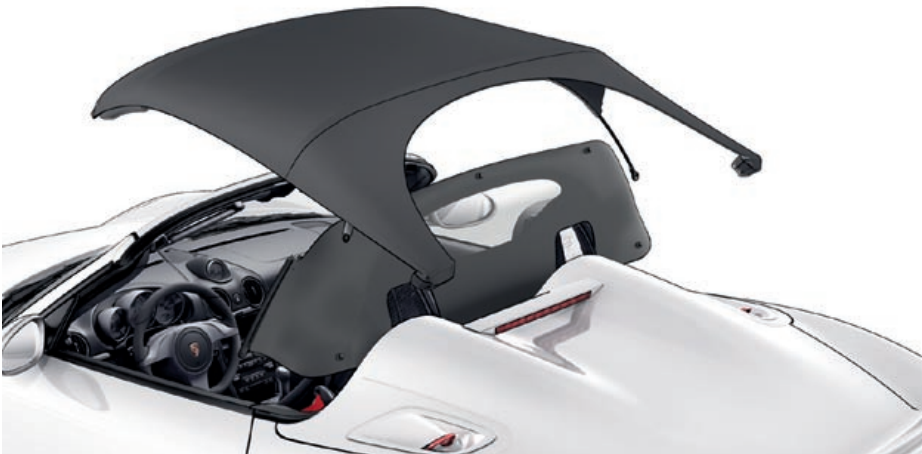
Toldo y protección contra las inclemencias
