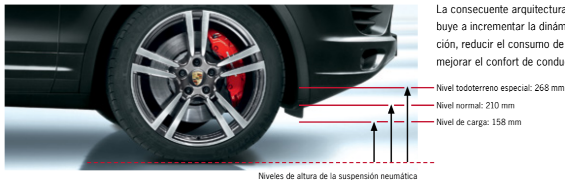
Niveles de altura de la suspensión neumática
