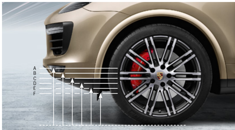
Suspensión neumática con PASM. Mayor dinámica y confort de conducción (página 54) 1)
