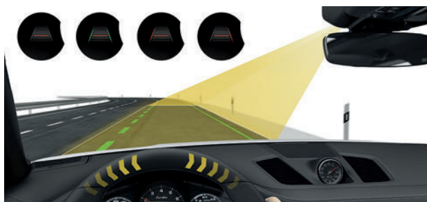
Asistente de mantenimiento de carril
