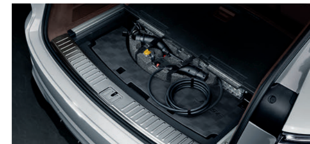
Cable de carga (Modo 3) para la carga en pedestales de carga públicos
