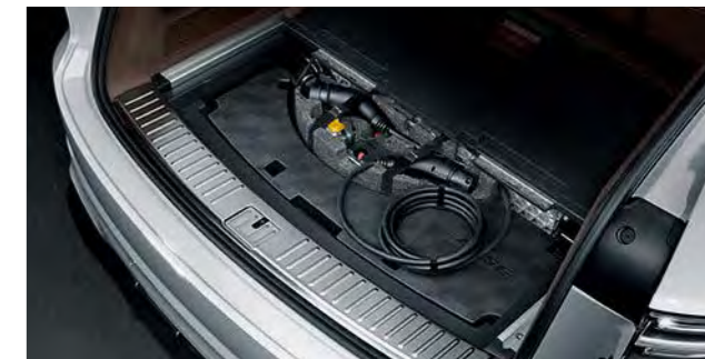
Cable de alimentación para carga en pedestales de carga (cable en espiral, alojado bajo el fondo del maletero)
