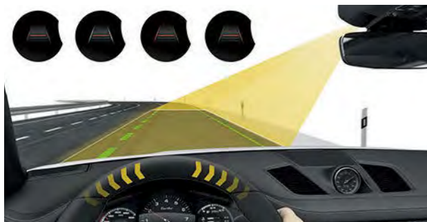
Asistente de mantenimiento de carril
