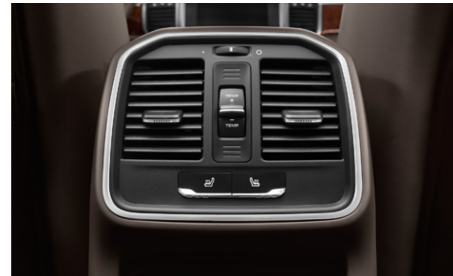
Botones de mando del climatizador trasero para climatizador automático de tres zonas
