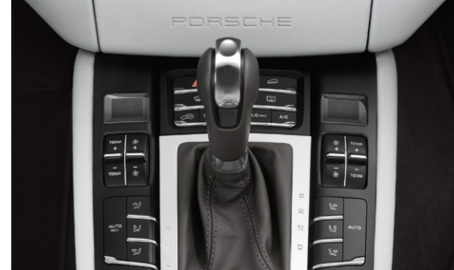
Botones de mando del climatizador delantero para climatizador automático de dos y tres zonas
