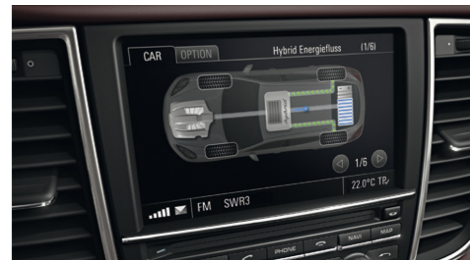
Indicación del flujo de energía en el Porsche Communication Management (PCM) opcional
