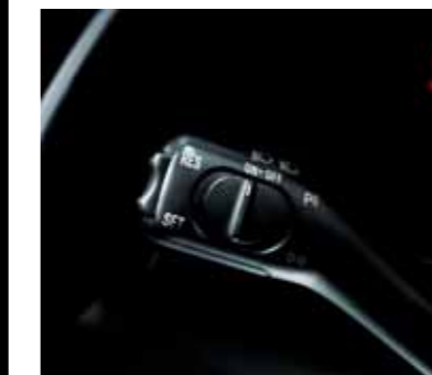
El control de navegación le permite controlar la velocidad, mantenerla o acelerarla con sólo tocar un botón.
