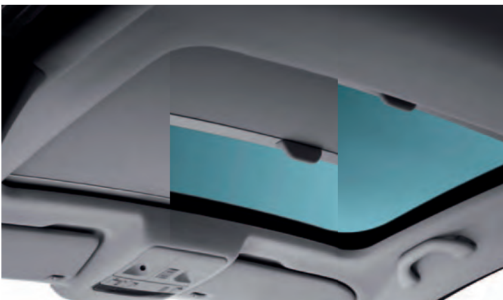
Techo eléctrico de cristal (panorámico).
