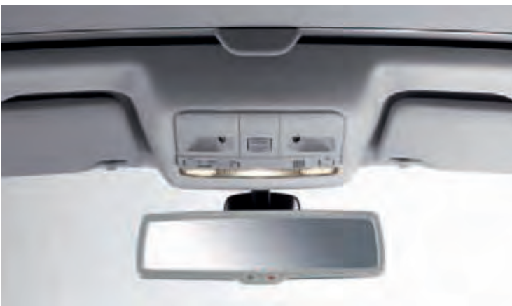
Espejo antideslumbrante con sensor de lluvia y sensor parking en Paquete Técnico.
