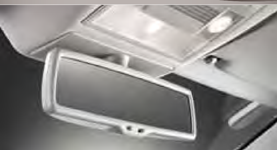
Un espejo retrovisor antideslumbramiento te protege mediante un sensor que oscurece automáticamente el espejo según la intensidad de la luz, ajustando el tono de forma gradual.
