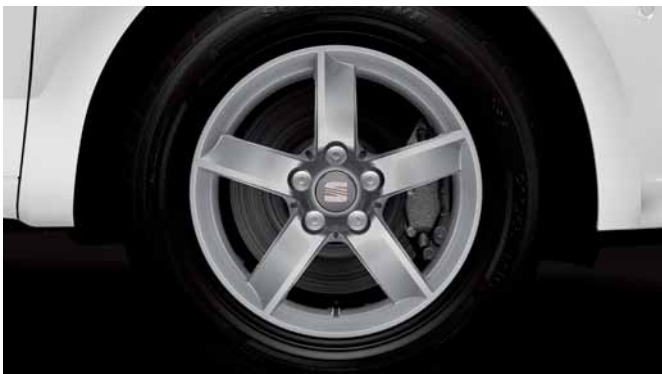
Llanta de aleación Izaros de 16" 6 ½J x 16" (205/55 R16") St R
