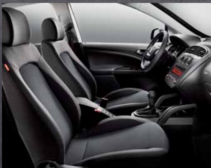
Asiento del conductor con regulación lumbar y en altura. Apoyacabezas ajustables en altura y rotación.
