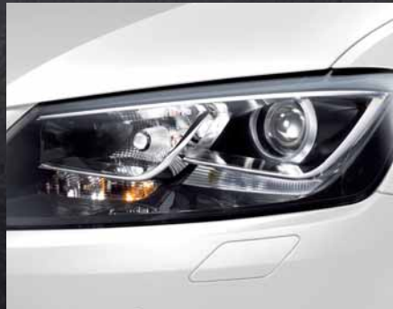
Los faros Bixenón con Sistema de Iluminación Adaptable iluminan donde más lo necesitas.
