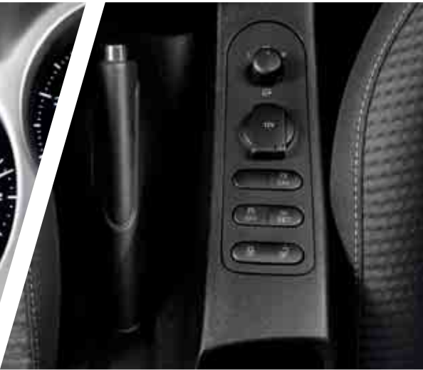
Selección de modo de conducción, gasolina o GLP en consola central.
