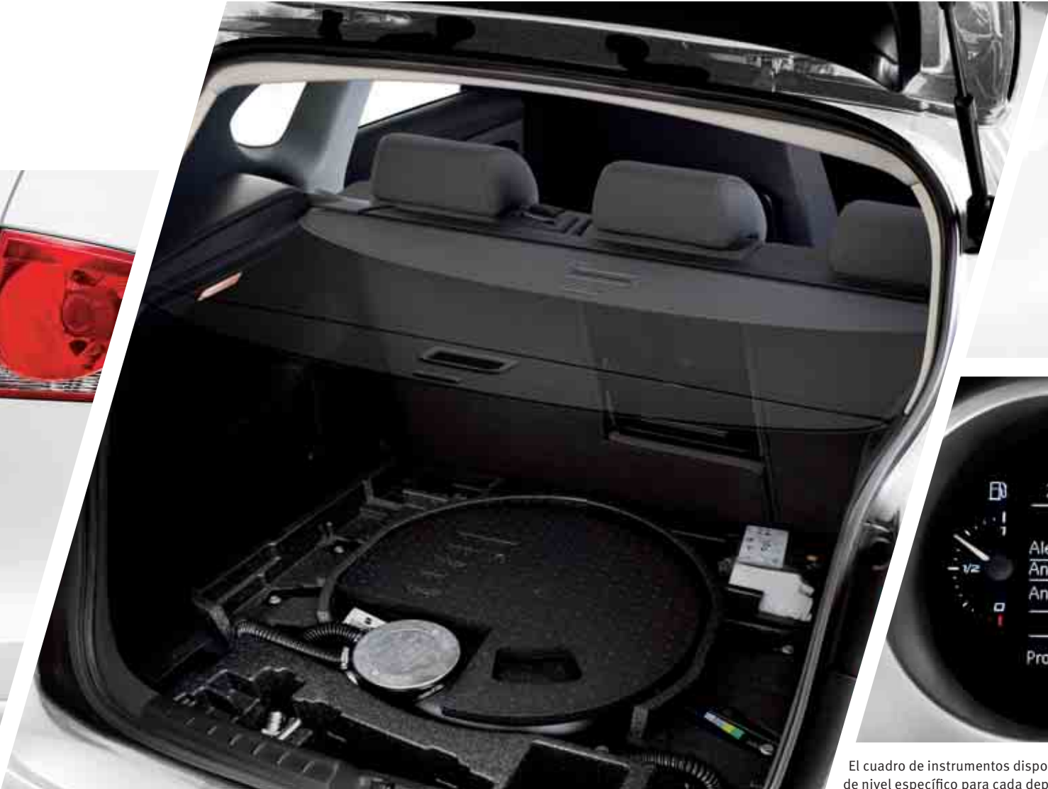
La ubicación del depósito GLP permite conservar capacidad de maletero.
