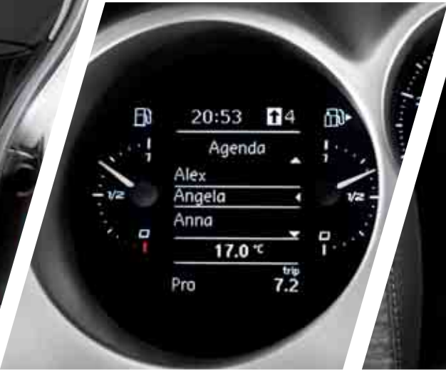
El cuadro de instrumentos dispone de un indicador de nivel específico para cada depósito.
