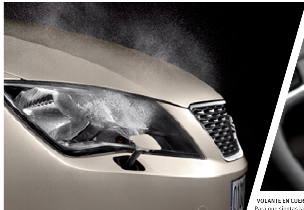
LIMPIA-LAVA FAROS DELANTEROS. Mantienen los faros limpios para una buena iluminación.
