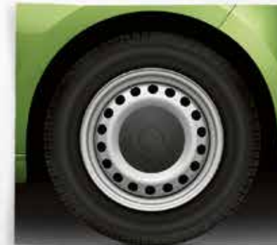
Llantas de acero 5.0J x 36 cm, neumáticos 165/70 R14 con tapacubos.
