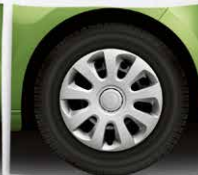
Llantas de acero 5.0J x 36 cm, neumáticos 165/70 R14 con tapacubos integrales Aries .
