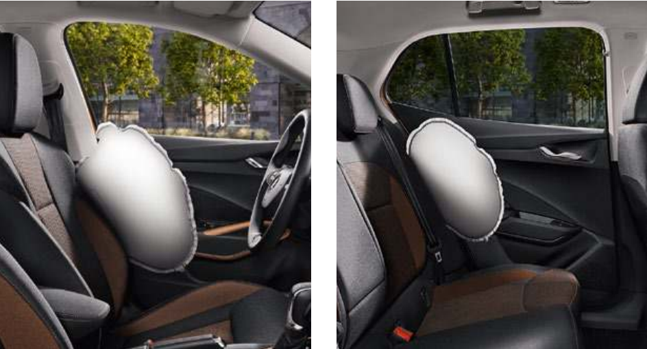
AIRBAGS LATERALES DELANTEROS Y TRASEROS Estos cuatro airbags protegen la pelvis y el pecho del conductor y de otros pasajeros en caso de colisión lateral.
