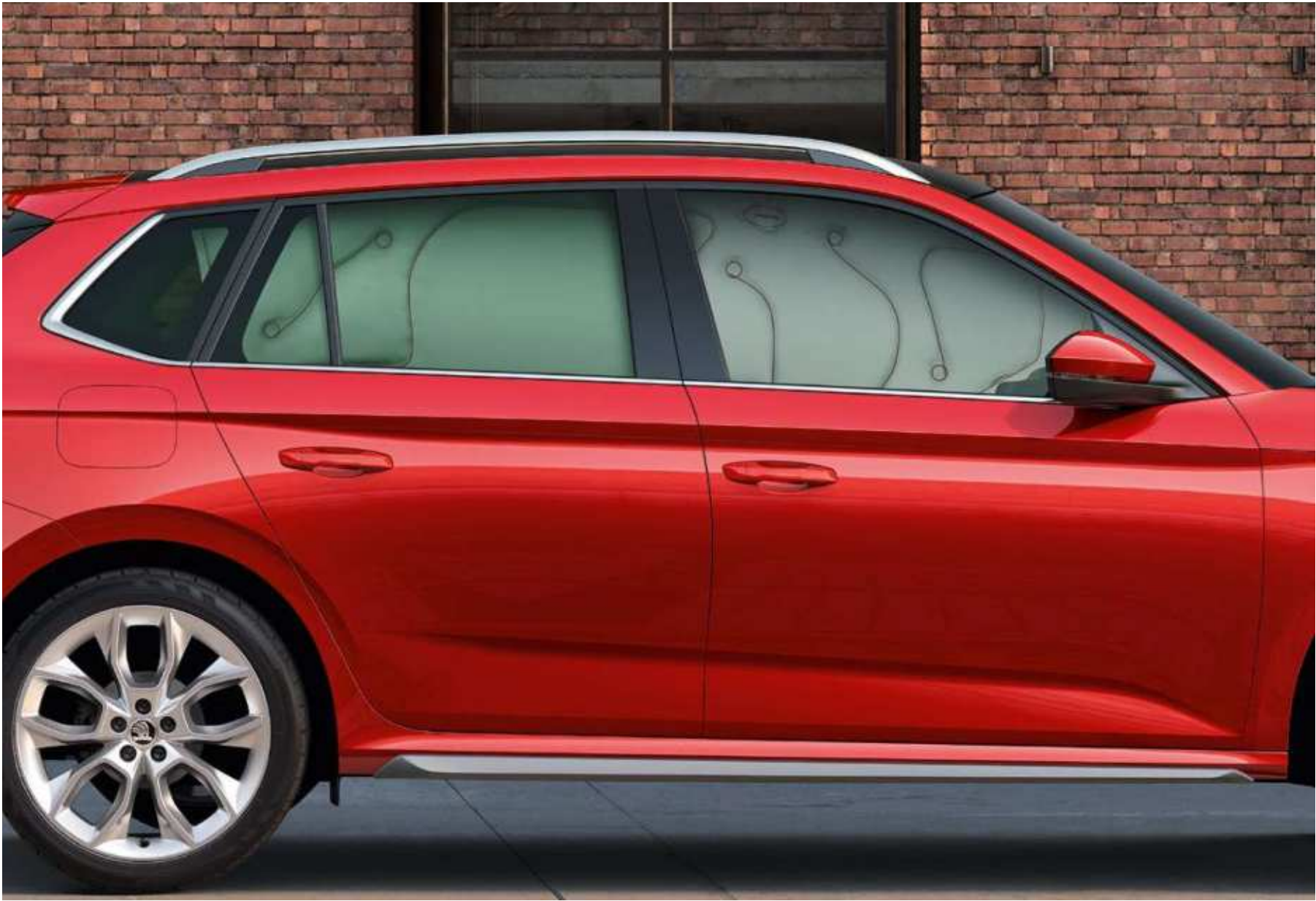
AIRBAGS DE CABEZA Cuando se activan, los airbags de cabeza evitan que los ocupantes delanteros y traseros sufran lesiones en la cabeza.
