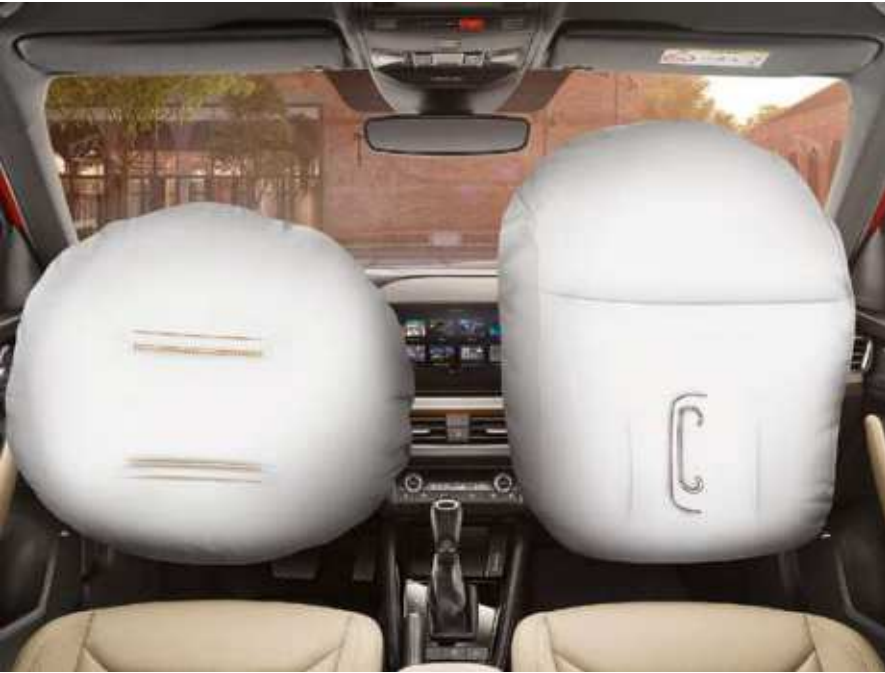
AIRBAGS FRONTALES El airbag del conductor está confinado en el volante; el del copiloto, en el salpicadero. Si es necesario, este último se puede desactivar para instalar una silla infantil en el asiento delantero.
