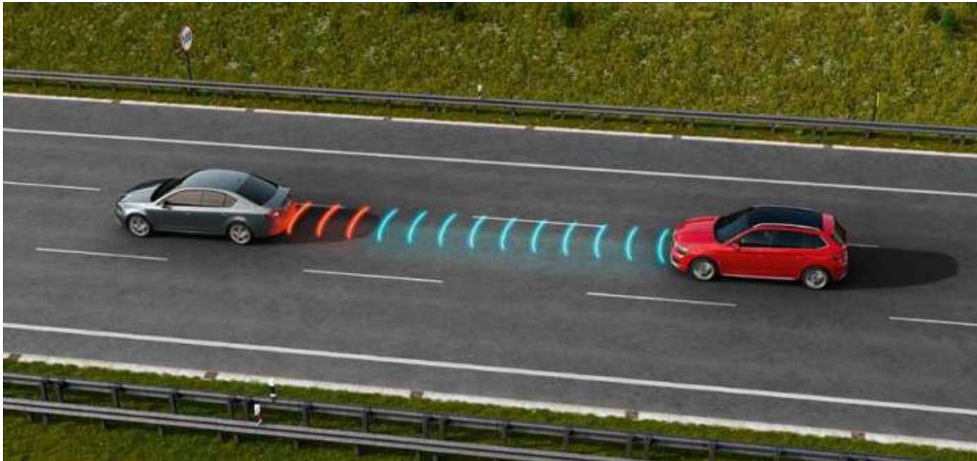
CONTROL ADAPTATIVO DE VELOCIDAD DE CRUCERO (ADAPTIVE CRUISE CONTROL) Utilizando el radar de la rejilla delantera y la función básica de control de velocidad de crucero, este sistema, que funciona en velocidades de hasta 210 km/h, mantiene la distancia de seguridad con los vehículos precedentes.
