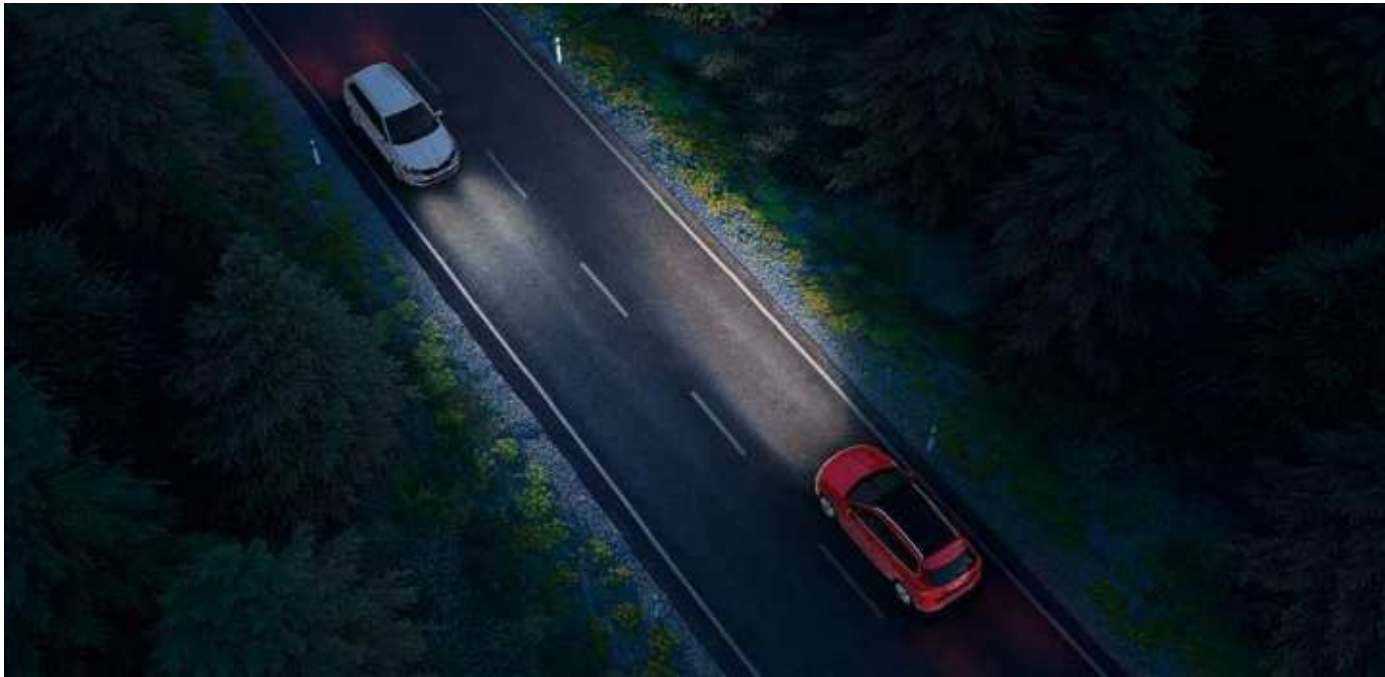
ASISTENTE AUTOMÁTICO DE LUCES DE CARRETERA (AUTO LIGHT ASSIST) Este asistente cambia automáticamente de luces cortas a luces largas y viceversa, aumentando el confort y la seguridad.
