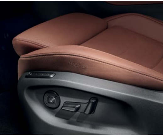
Ajuste eléctrico para ambos asientos delanteros izquierdos con función memoria
