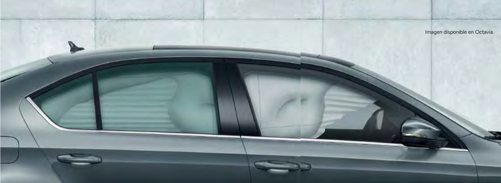
AIRBAGS DE CABEZA Al activarse, los airbags de cabeza crean un acolchado que protege de lesiones en la cabeza tanto a los pasajeros delanteros como a los traseros.
