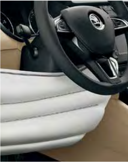
AIRBAG DE RODILLAS Este airbag, ubicado debajo de la columna de dirección, protege las rodillas y las espinillas del conductor.
