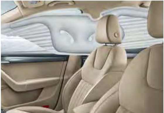
AIRBAGS DE CABEZA Al activarse, los airbags de cabeza crean un acolchado que protege de lesiones en la cabeza tanto a los pasajeros delanteros como a los traseros.
