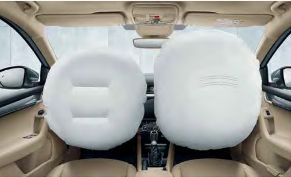
AIRBAGS DELANTEROS PARA EL CONDUCTOR Y EL ACOMPAÑANTE Mientras que el airbag para el conductor está instalado en el volante, el airbag para el acompañante se encuentra en el salpicadero. Este último puede ser desactivado en el caso de que se instale una silla infantil en el asiento delantero.
