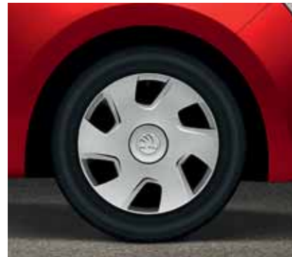
Llantas de acero Dakara 6.0J x 15" para neumáticos 185/60 R15
