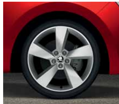
Llantas de aleación Camelot 7.0J x 17" para neumáticos 215/40 R17
