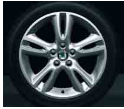
Llantas de aleación ATRIA 6.5J x 16" para neumáticos 205/45 R16.
