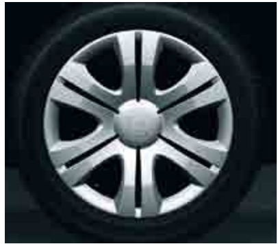
Llantas de acero SATELLITE 6J x 15" para neumáticos 195/55 R15.
