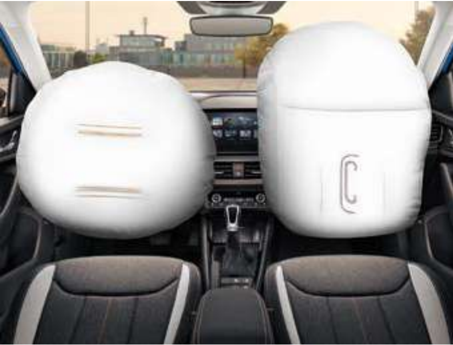
AIRBAGS FRONTALES El airbag del conductor está en el volante; el del copiloto, en el salpicadero. Si es necesario, este último se puede desactivar para instalar una silla infantil en el asiento delantero.
