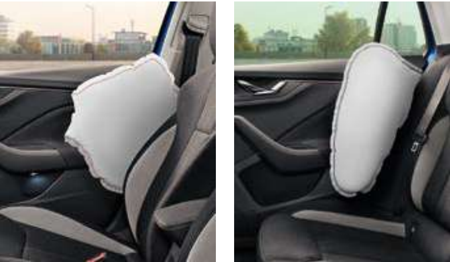
AIRBAGS LATERALES DELANTEROS Y TRASEROS Estos cuatro airbags protegen la pelvis y el pecho del conductor y de otros pasajeros en caso de colisión lateral.
