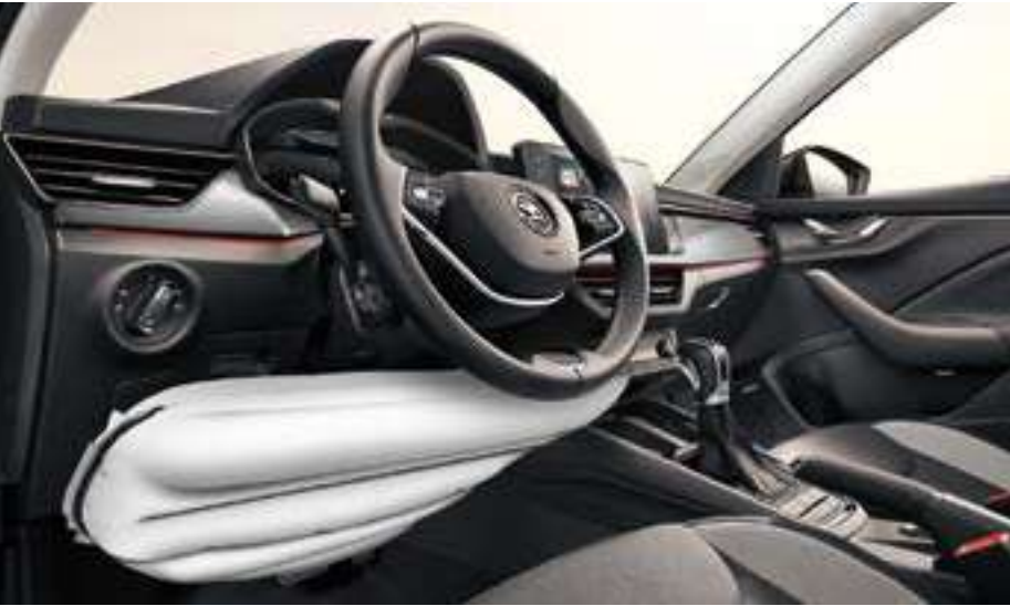
AIRBAG DE RODILLAS Este airbag se encuentra bajo la columna de dirección y protege las rodillas y espinillas del conductor.
