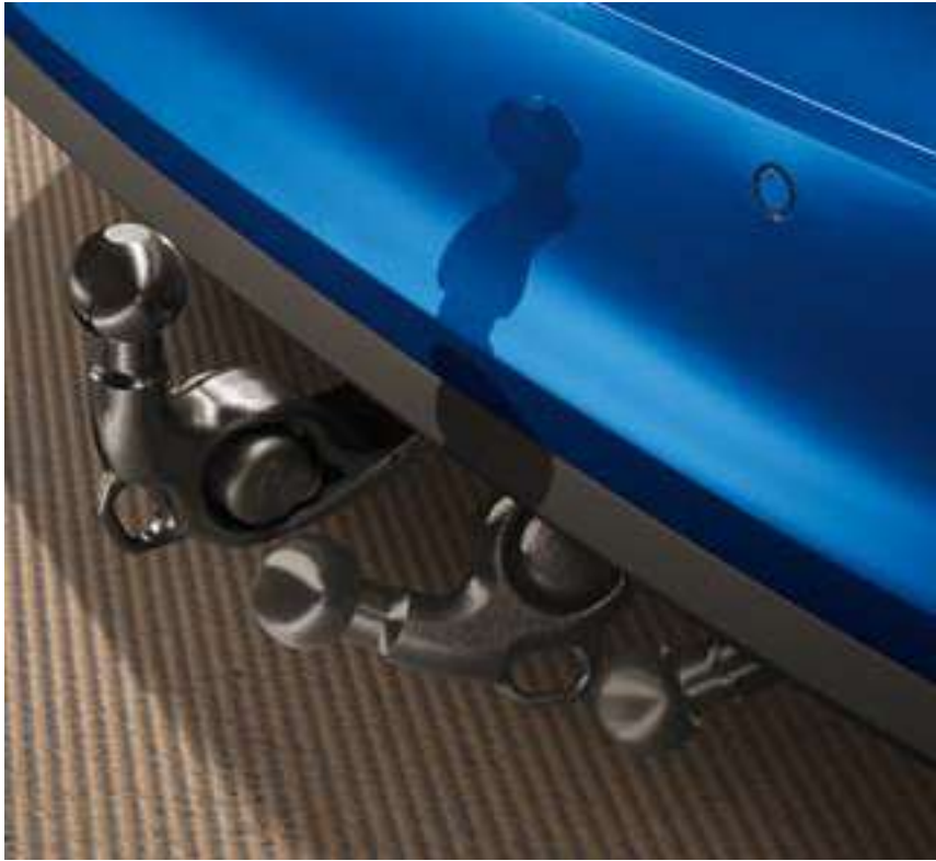
REMOLQUE El SCALA lleva un remolcado plegable con accionamiento eléctrico.El interruptor está en el maletero.
