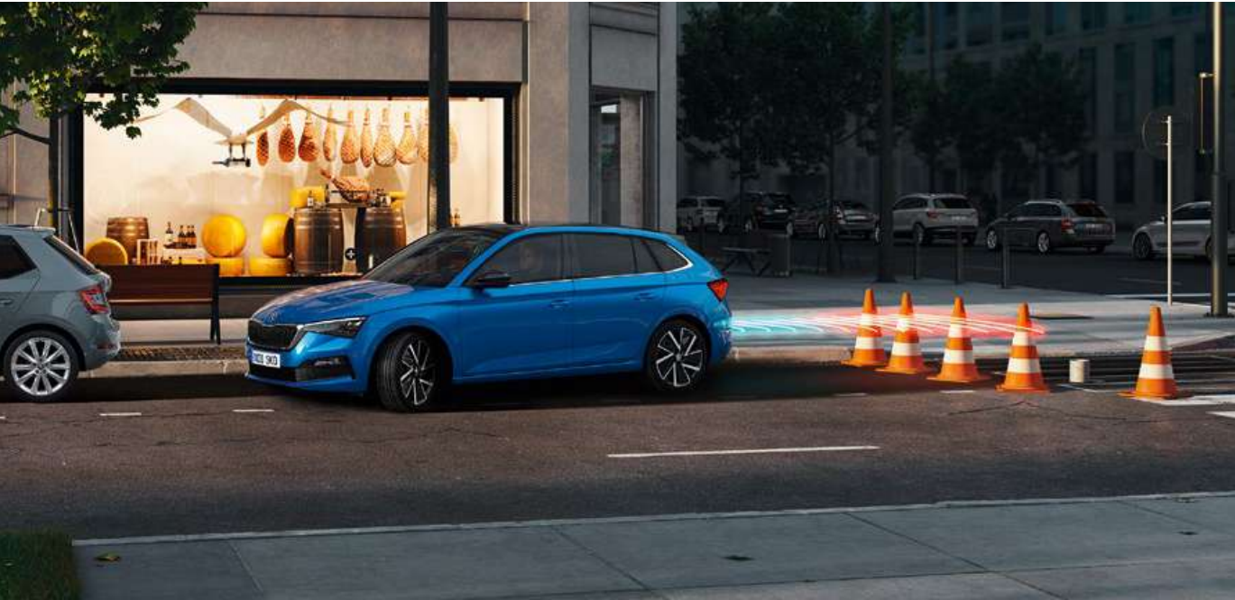
ASISTENTE DE ESTACIONAMIENTO (MANOEUVRE ASSIST) Este sistema usa los sensores del asistente de estacionamiento para proteger al vehículo de obstáculos cercanos (hasta 8 km/h). Si detecta un obstáculo, el sistema activa el freno de emergencia en función de la distancia y la velocidad del vehículo.
