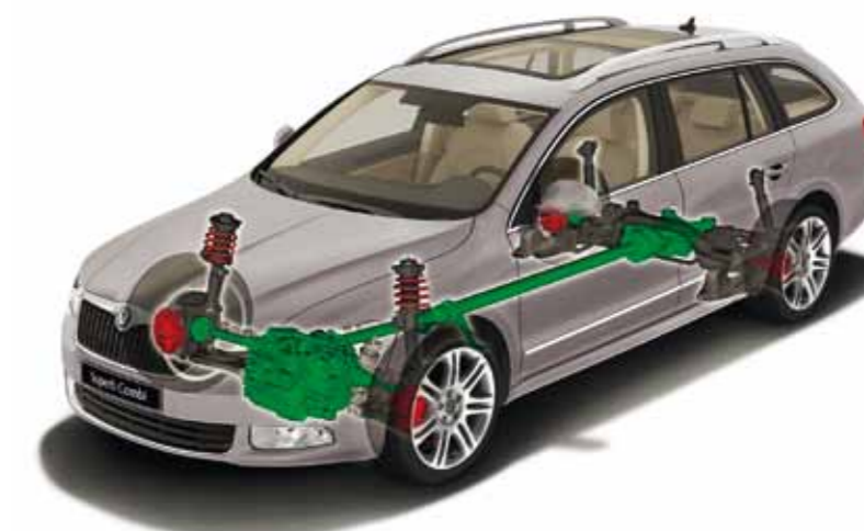
Škoda Superb Combi con tracción 4x4 y embrague Haldex de 4ª generación (motores 1.8 TSI 160CV; 3.6 FSI V6 260CV y 2.0 TDI CR 170CV).
