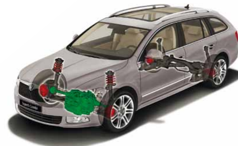
Škoda Superb Combi con tracción delantera (disponible para todos los motores excepto para el 3.6 FSI V6 260CV).
