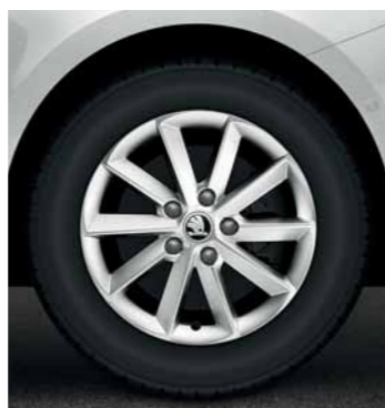
La versión GreenLine en el acabado Ambition se equipa con llantas de aleación Helix 7.0J x 16" con neumáticos 205/55 R16, que presentan poca resistencia a la rodadura (en la foto). El acabado Active presenta llantas de aleación Spectrum 7.0J x 16" .
