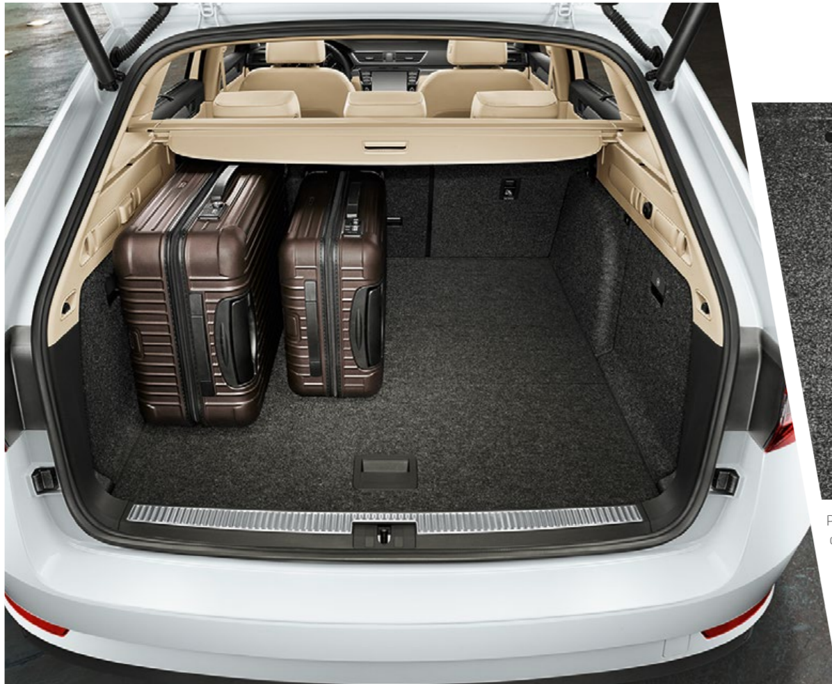
Las medidas del maletero son excepcionales. La versión combi ofrece 660 litros, que se amplían hasta 1.950 litros con los respaldos de los asientos traseros abatidos. El liftback también te impresionará por su capacidad de 625/1.760 litros.
