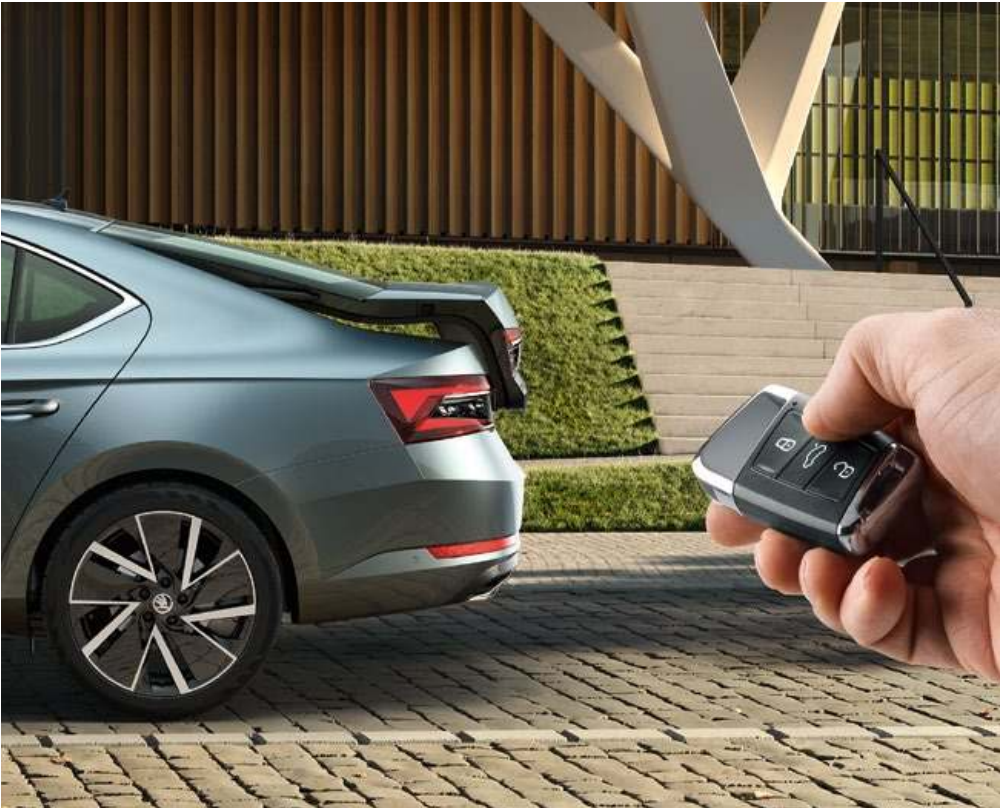
PORTÓN TRASERO CONTROLADO ELÉCTRICAMENTE Y PEDAL VIRTUAL El portón trasero con control eléctrico se abre y se cierra con solo tocar el botón del control remoto, el del panel central o directamente en el portón. La posición del portón es totalmente ajustable a tu necesidad. Este también puede equiparse con un pedal virtual que permite el acceso sin contacto.
