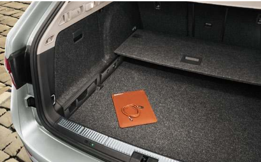
DOBLE FONDO El doble fondo permite un manejo del equipaje más sencillo junto a un espacio de almacenamiento más discreto, gracias a que la base del maletero se encuentra al nivel del borde de carga.
