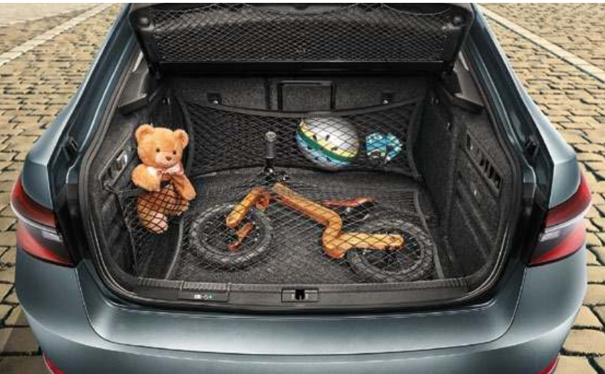
REDES El sistema de redes sirve para asegurar los objetos y aumentar la flexibilidad del maletero. Está formado por una red horizontal y dos verticales. En la versión limo se puede añadir una red extra bajo la cubierta del maletero.
