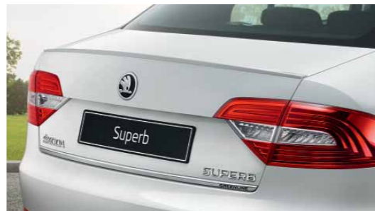
El spoiler de la puerta del maletero contribuye en gran parte a la reducción del coeficiente de la fuerza de arrastre del modelo Superb GreenLine. La etiqueta GreenLine también aparece en la parte trasera del coche.
