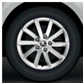
La versión GreenLine en el acabado Ambition se equipa con llantas de aleación Helix 7.0J x 16" con neumáticos 205/55 R16, que presentan poca resistencia a la rodadura (en la foto). El acabado Active presenta llantas de aleación Spectrum 7.0J x 16" .
