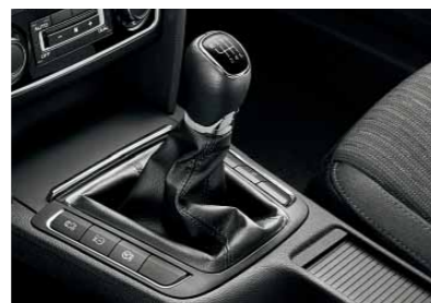
El sistema Start-Stop detiene automáticamente el motor cuando, por ejemplo, estás esperando en un semáforo o te mueves despacio en un atasco. Al pisar el pedal de embrague, el motor arranca automáticamente. El conductor puede desactivar el sistema Start-Stop con un botón ubicado en la consola central. La funcionalidad de recuperación de energía , que permite utilizar de forma efectiva la energía cinética del coche para recargar la batería, también influye en la reducción de la carga del motor y en un funcionamiento más económico del vehículo.
