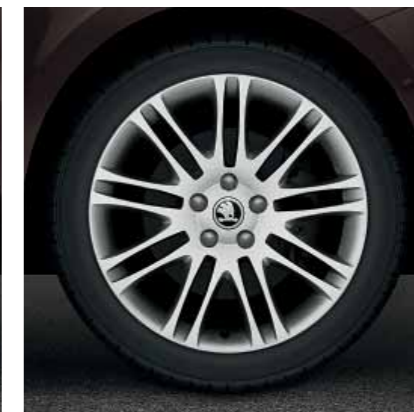
Llantas de aleación Luxon 7.5J x 18" con superficie pulida para neumáticos 225/40 R18.
