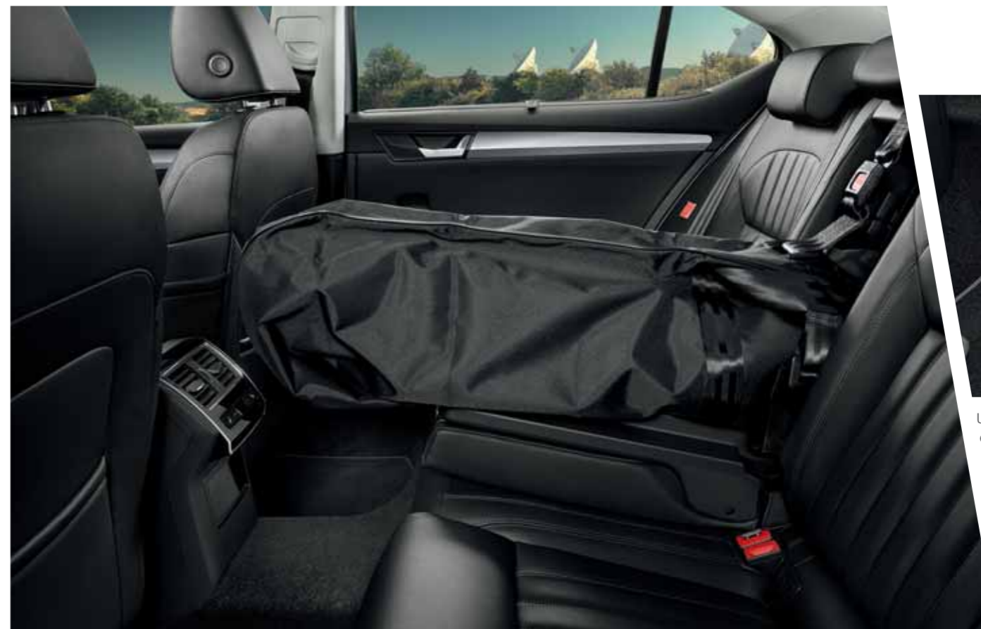
La bolsa Unibag extraíble, diseñada para transportar esquís o una tabla de snowboard, puede colocarse en la abertura que comunica el maletero con el habitáculo.
