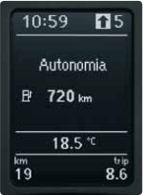
El panel de instrumentos indica la marcha recomendada . Gracias a esta función sabrás si has seleccionado la marcha correcta o si debes cambiarla para mantener las revoluciones óptimas del motor que te permitirán mantener un bajo consumo de combustible.
