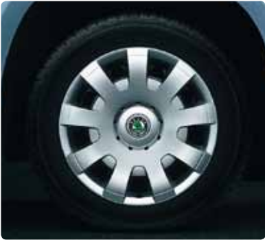
Llantas de acero 7.0J x 16" para neumáticos 215/60 R16 y embellecedores RIF.
