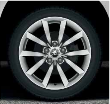
Llantas de aleación Scudo 7.0J x 17" para neumáticos 225/50 R17; Yeti
