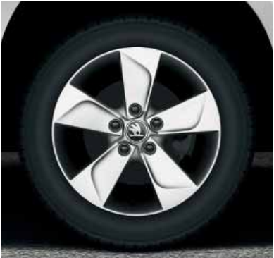
Llantas de aleación Nevis 7.0J x 16" para neumáticos 215/60 R16; Yeti Outdoor
