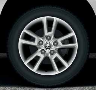
Llantas de aleación Forest 7.0J x 16" para neumáticos 215/60 R16; Yeti Outdoor
