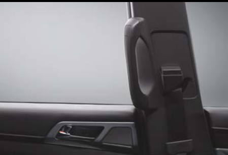
Asideros en el interior del pilar B
