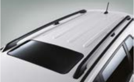
Techo solar eléctrico y rieles en techo
