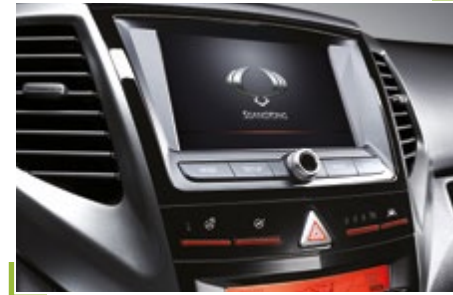
Sistema de Navegación con pantalla táctil de 8".
