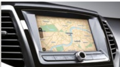
Sistema de Navegación con pantalla táctil de 8".
