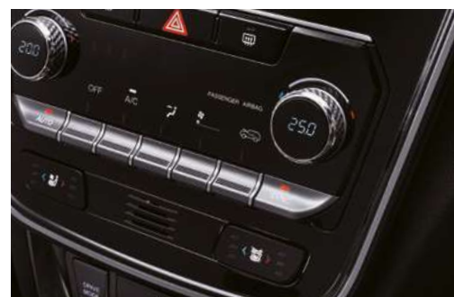
Climatizador automático bizona.
