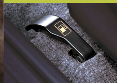
Apertura remota depósito combustible
