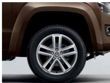
Las llantas de aleación ligera "Cantera" 8 J x 19, con pasos de rueda ensanchados. Con neumáticos 255/55 R 19.
