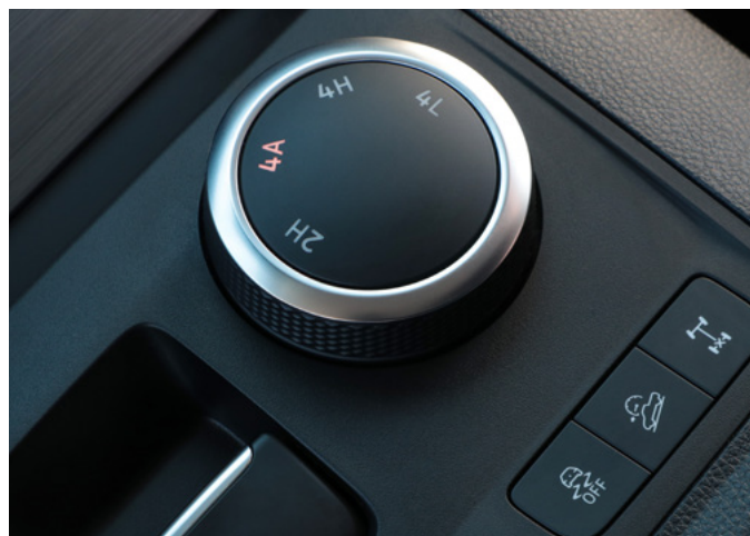
Conmutador de tracción integral conectable 4MOTION y botón de bloqueo del diferencial (derecha) en la consola central.
