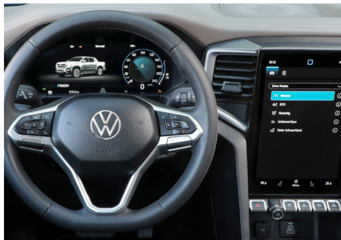
Visualización del modo de conducción "Normal" en el sistema de infotainment y animación del modo de conducción en el panel de instrumentos digital.
