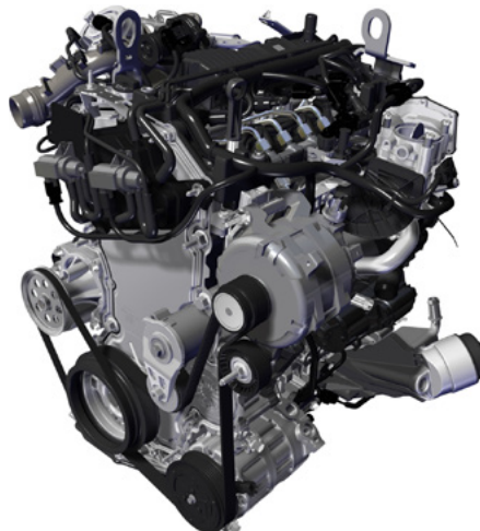
Motor TDI V4 de 2.0 litros con 151 kW (205 CV)/ 500 Nm (BiTurbo).
