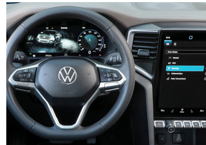
Visualización del modo de conducción "Slippery" en el sistema de infotainment y animación del modo de conducción en el panel de instrumentos digital.
