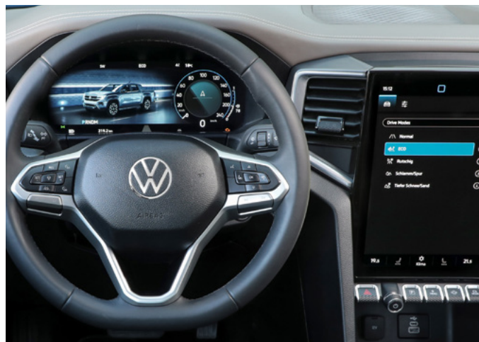
Visualización del modo de conducción "ECO" en el sistema de infotainment y animación del modo de conducción en el panel de instrumentos digital.
