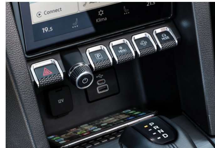
Botones de función, botón de encendido/apagado y control del volumen del sistema de infotainment (a partir del modelo Style con entorno cromado), toma de corriente de 120 voltios, interfaz USB-A y USB-C, y compartimento para móviles (a partir del modelo Style, con función de carga inductiva, opcional en los demás modelos) en el compartimento de almacenamiento debajo de la pantalla táctil a color.
