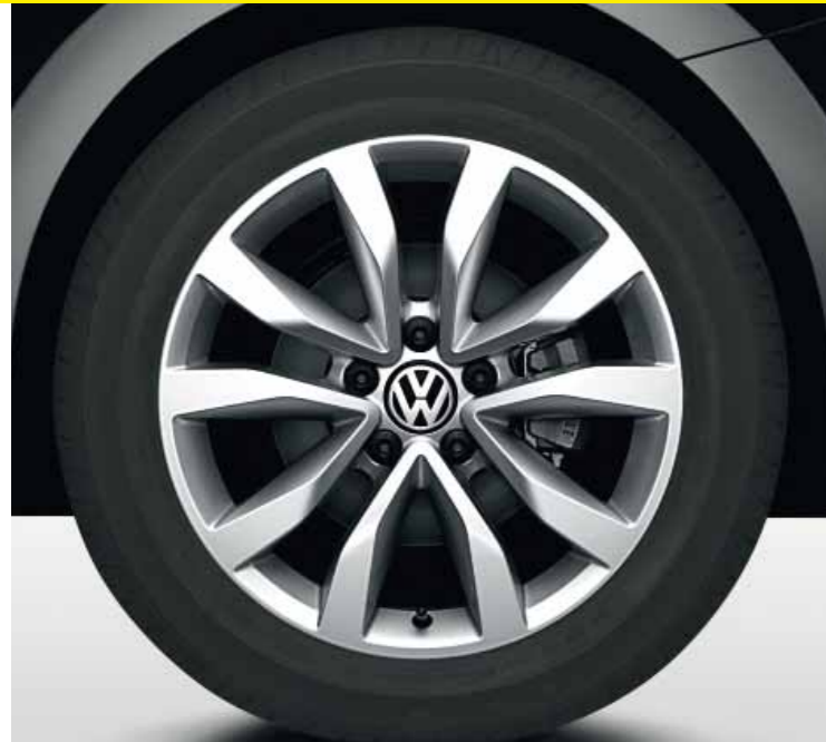
La llanta de aleación ligera de 17 pulgadas “Talaia” y neumáticos 215/55 R17. | D
