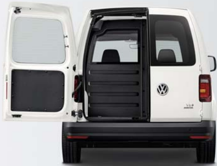
Puerta trasera de dos hojas con apertura de ventanilla dividida asimétricamente (2/5 a 1/5) para Caddy Furgón y Kombi
