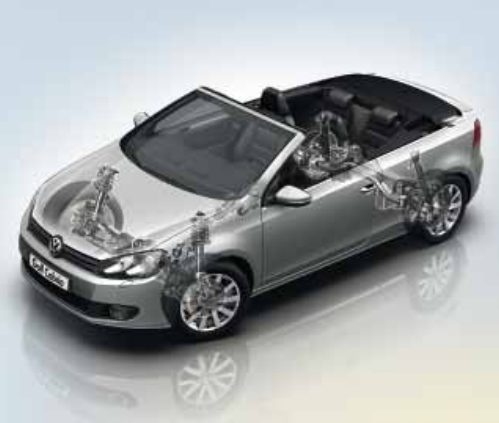
SUSPENSIÓN ADAPTATIVA (DCC) | O El ajuste electrónico de amortiguadores permite adaptar el modo de conducción en función de la superficie por la que se circula, gracias a los tres niveles de dureza: Normal, Comfort y Sport.
