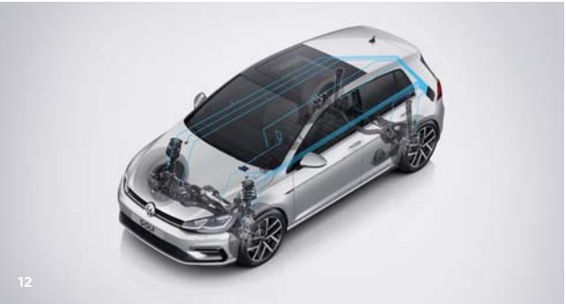
(sin imagen) El asistente de mantenimiento de carril “Lane Assist” detecta si el vehículo se sale del carril a partir de una velocidad de 65 km/h. El sistema ayuda al conductor a mantener el vehículo dentro del carril. 1) O
