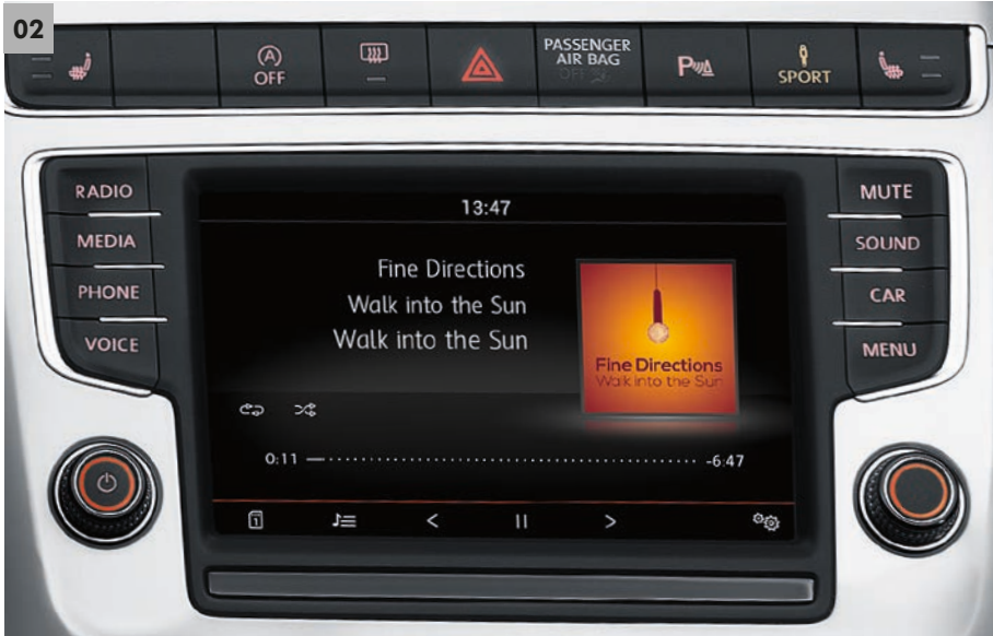
02 SISTEMA DE RADIO “COMPOSITION MEDIA”. El sistema de radio “Composition Media” posee una pantalla TFT en color de 16,5 cm (6,5 pulgadas), una pantalla táctil con sensores de aproximación y un lector de CD compatible con los formatos MP3 y WMA. Seis altavoces con una potencia de 4 x 20 vatios convierten al equipo en toda una experiencia multimedia. Cuenta además con un lector de tarjetas SD, una toma AUX-IN, un puerto USB y una conexión Bluetooth para teléfonos móviles. [O]
