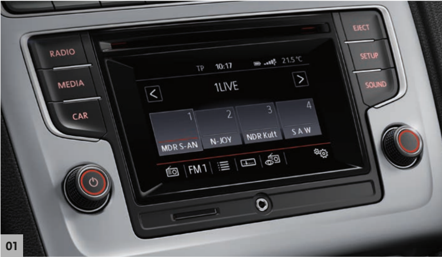
02 SISTEMA DE RADIO “COMPOSITION MEDIA”. El sistema de radio “Composition Media” posee una pantalla TFT en color de 16,5 cm (6,5 pulgadas), una pantalla táctil con sensores de aproximación y un lector de CD compatible con los formatos MP3 y WMA. Seis altavoces con una potencia de 4 x 20 vatios convierten al equipo en toda una experiencia multimedia. Cuenta además con un lector de tarjetas SD, una toma AUX-IN, un puerto USB y una conexión Bluetooth para teléfonos móviles. [O]
